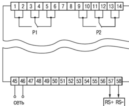
**Рис. Б.5. Подключение выходных реле**
