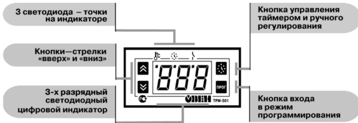
Рисунок 3.1 – Лицевая панель прибора
