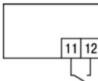
**Рисунок 6.6 – Схема подключения внешней кнопки «СТОП/ПУСК»**
