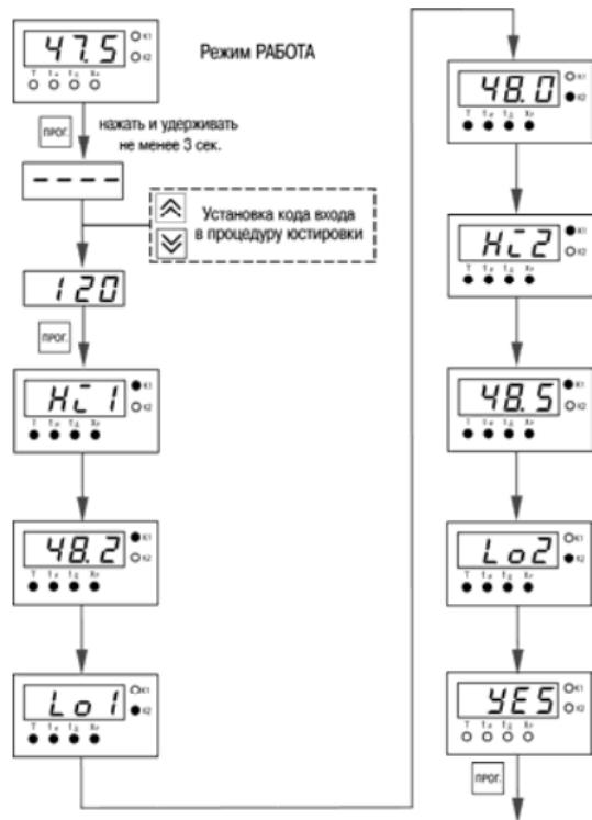
Рис. Е.2. Последовательность запуска и индикации АНР для TPM12-Щ1.Р
