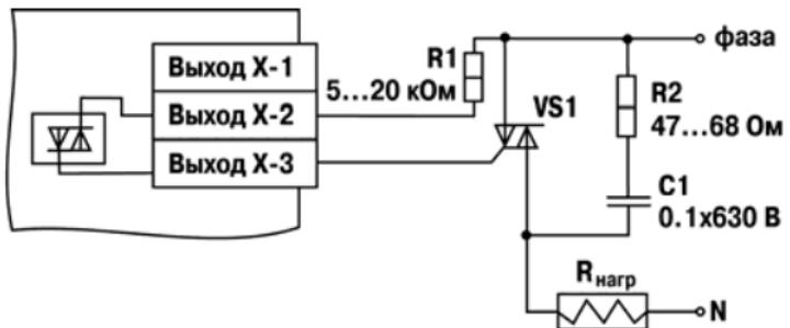
**Рис. Б.3. Схема подключения силового симистора к ВУ типа С**
