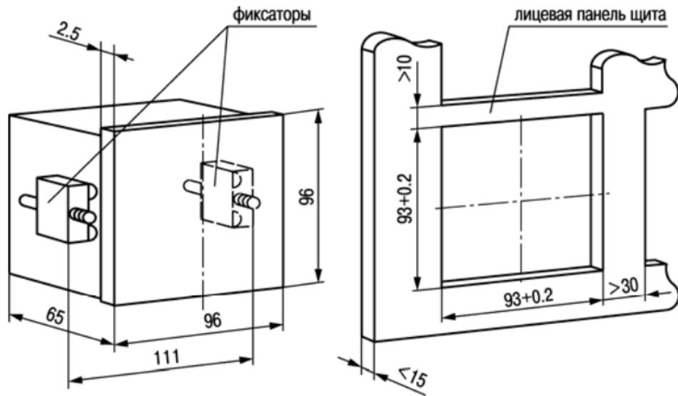
Рис. А.2. Прибор щитового крепления Щ1
