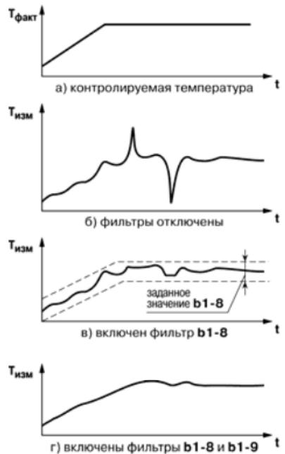
Рис. 3.2. Временные диаграммы работы Цифровых фильтров
