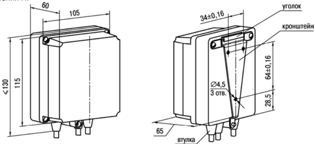
Рис. А.1. Прибор настенного крепления Н
