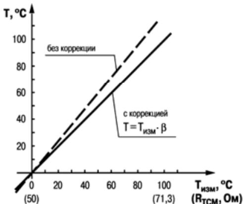
Рис. 3.4. Коррекция “наклон характеристики”
