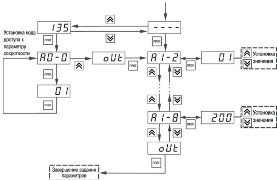
**Рис. 6.3. Последовательность работы с прибором на втором уровне программирования (для группы параметров А)**
