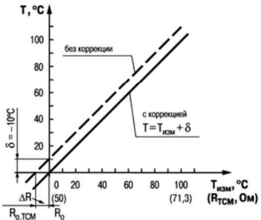
Рис. 3.3. Коррекция “сдвиг характеристики”
