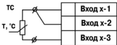
Рис. Б.5. Схема подключения термометра сопротивления
