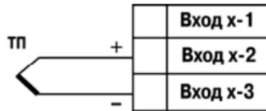
Рис. Б.6. Схема подключения термоэлектрического преобразователя
