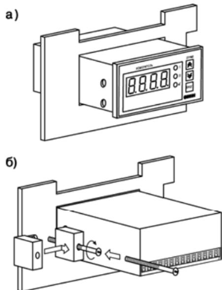
Рис. 5.2. Монтаж прибора щитового крепления
