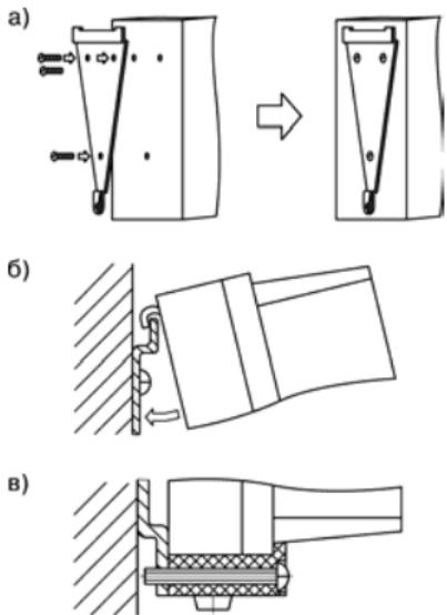
Рис 5.1. Монтаж прибора настенного исполнения
