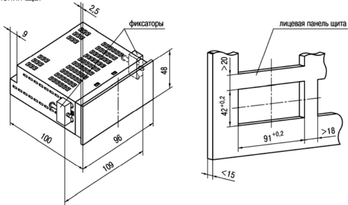
Рис. А.3. Прибор щитового крепления Щ2
