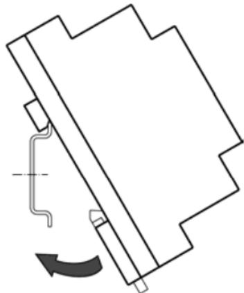
**Рис. 5.3. Монтаж прибора с креплением на DIN-рейку**
