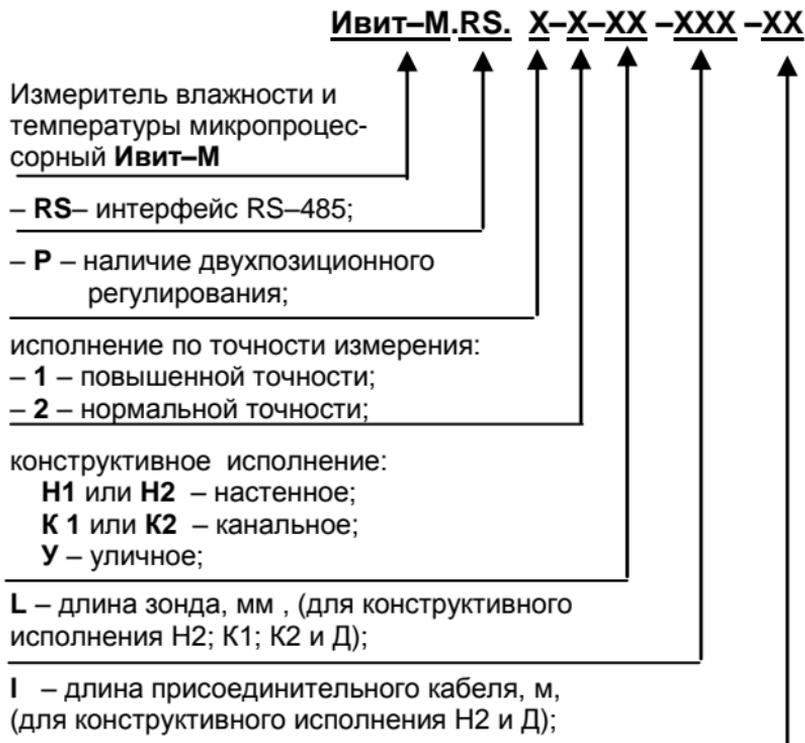
Пример записи прибора при заказе:
