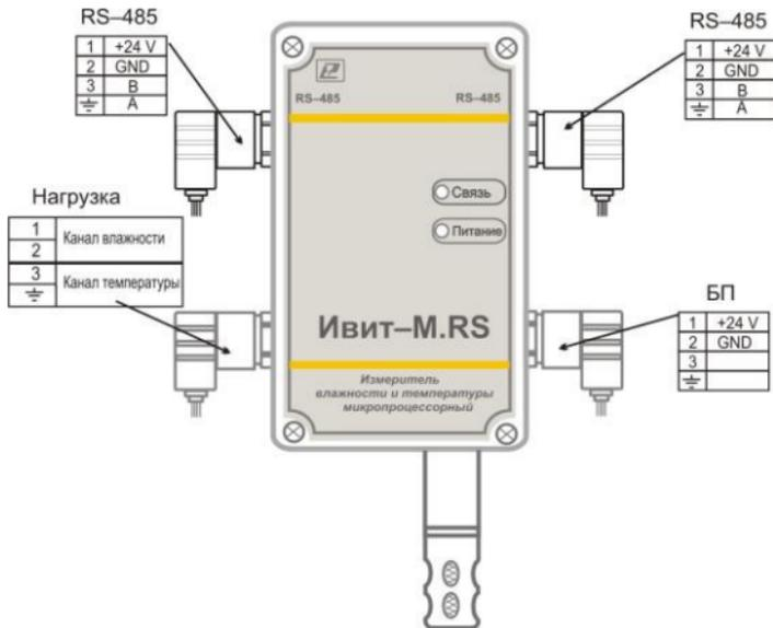
При наличии в приборе функции двухпозиционного регулирования (Ивит-М.РС.Р) необходимо использовать внешнее питание (вход БП).
