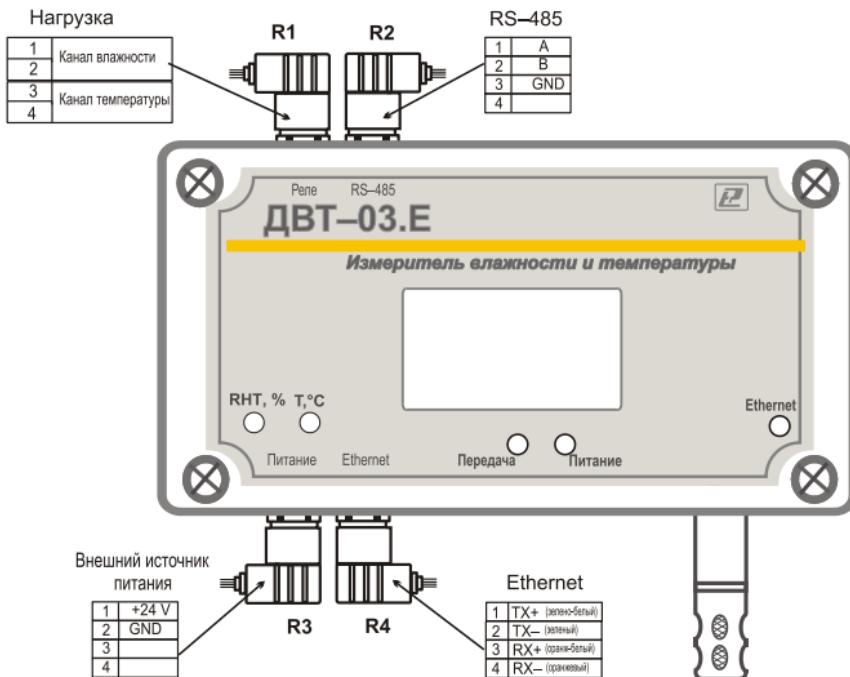
Разъёмы для подключения – соединители DIN43650:
