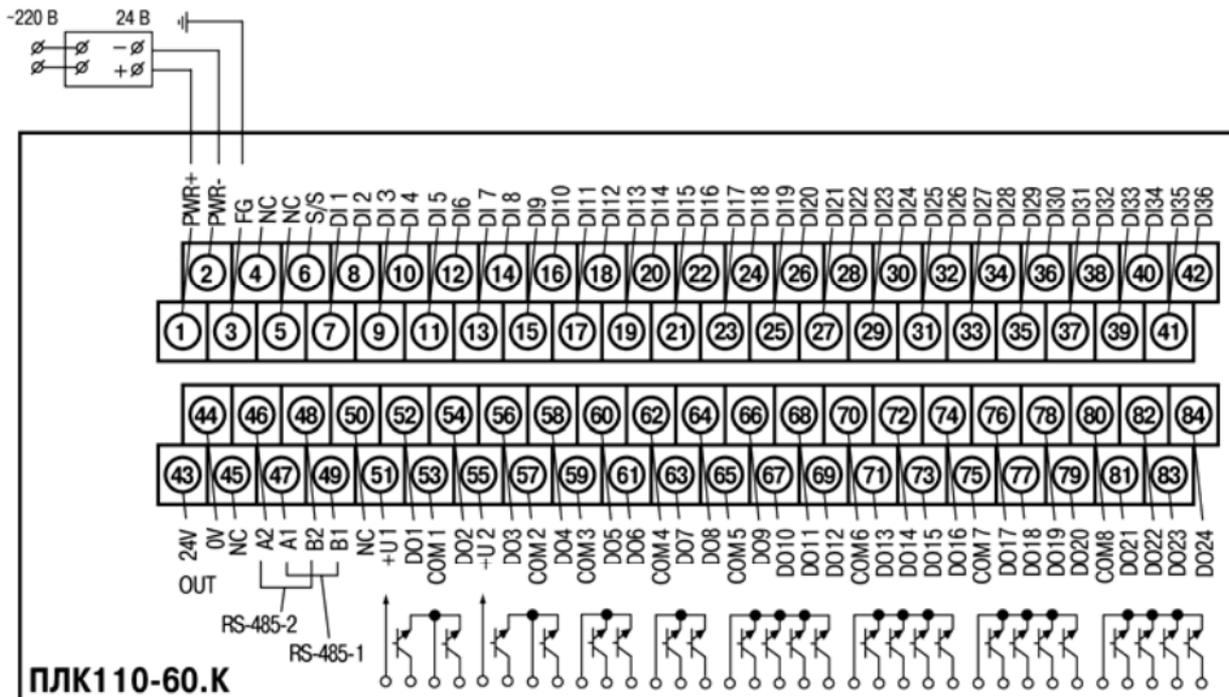
**Рисунок Б.2 – Схема расположения и назначение клемм на ПЛК110-24.60.К.
