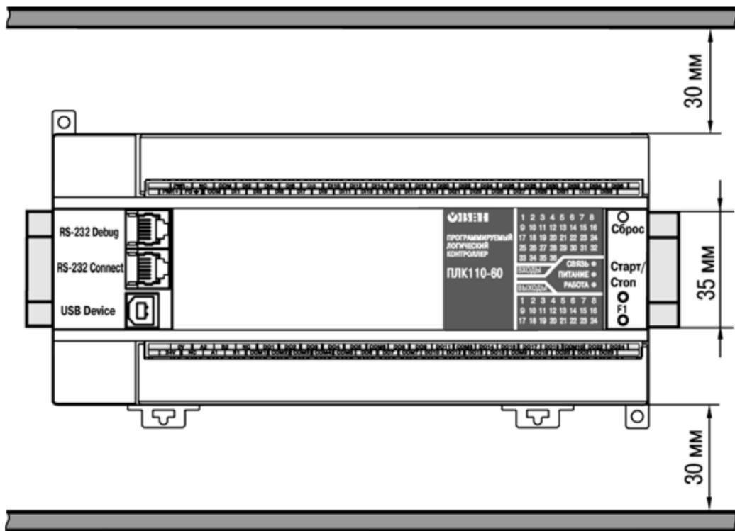
**Рисунок А.4 – Расстояние до стенок корпуса ПЛК при монтаже для обеспечения вентиляции**
