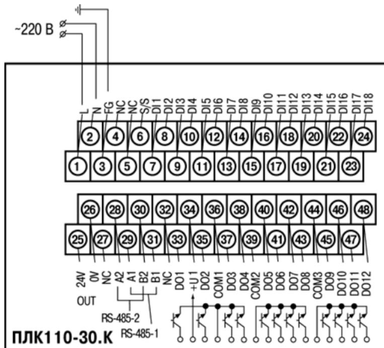
Рисунок Б.6 – Схема расположения и назначение клемм на ПЛК110-220.30.К
