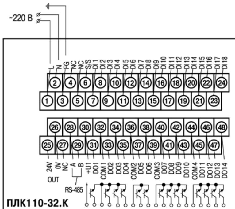
Рисунок Б.4 – Схема расположения и назначение клемм на ПЛК110-220.32.К
