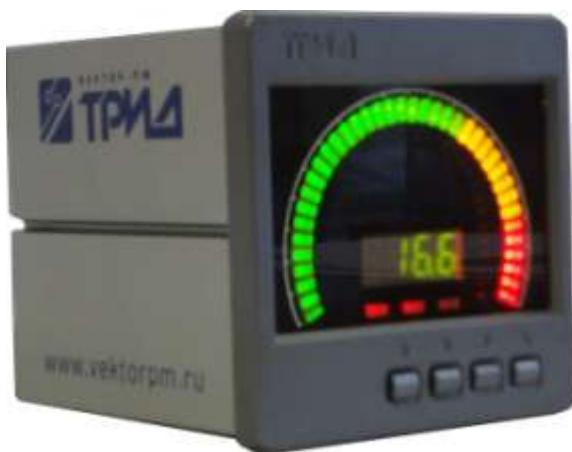
Тахометры-сигнализаторы ТРИД ТХС предназначены для измерения значения скорости вращения, а также осуществления контроля и регулирования измеренных значений путем осуществления аварийно-предупредительной сигнализации. Приборы данной серии специализированы для работы с датчиками Холла и энкодерами, имеют минимальный набор функций, что делает их экономичными и простыми в использовании.
