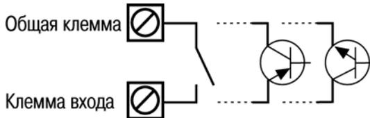
Рис. 6.1. Схема подключения датчиков к дискретным входам
