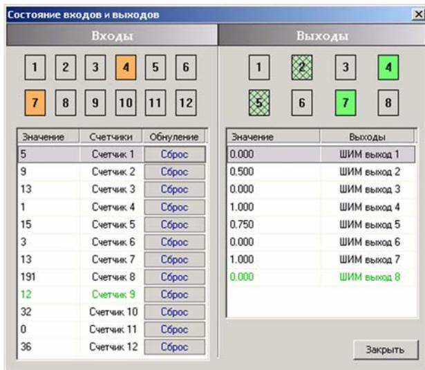
**Рис. 4.3. Окно монитора процесса состояний входов и выходов**
