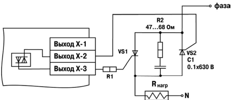
Рис. 5.3. Схема подключения двух тиристоров, подключенных встречно-параллельно
