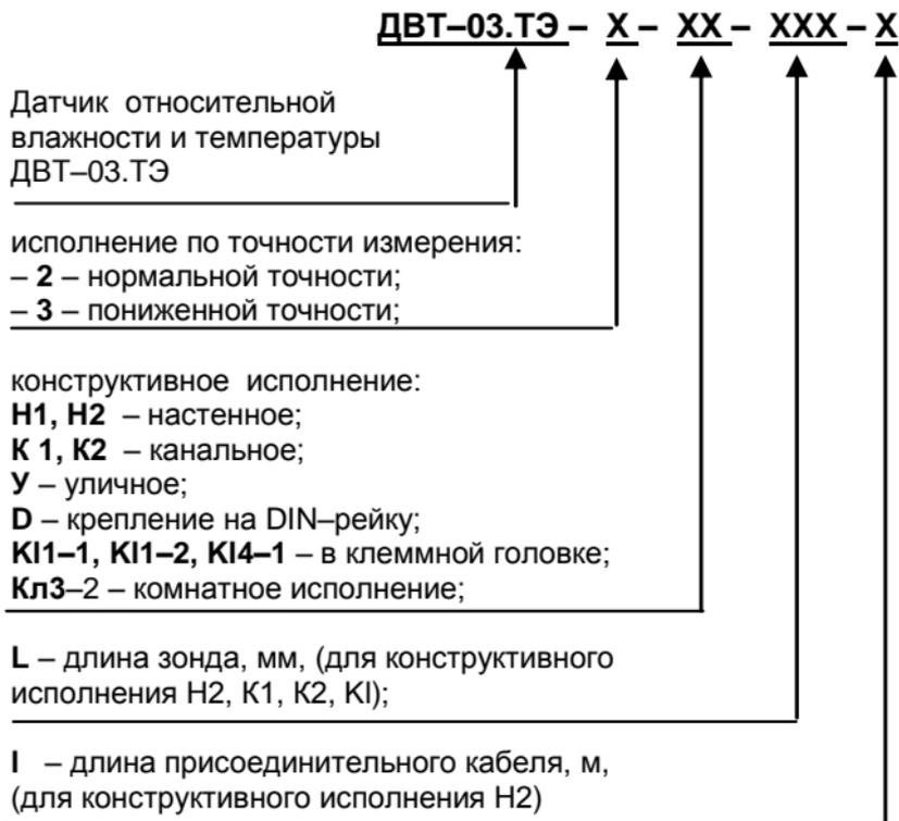
Пример записи датчика при заказе:
